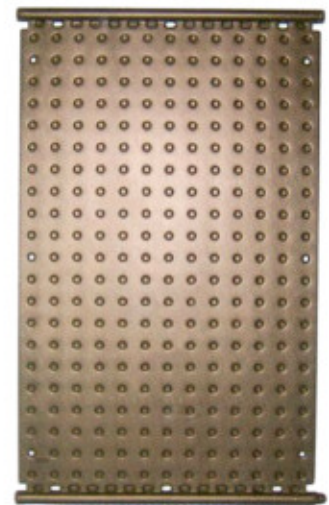
Art.-Nr. 1002 mit integriertem Sammelrohr Ø 40 mm an beiden Schmalseiten Länge 1.360 mm - Breite 820 mm - 1.12 m 2
